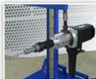
EB-1 Rolling Motors operated by TES100. Antriebsmaschinen EB-1 , bedient durch TES100. Rozwalcarki do rur EB-1 obsługiwane przez TES100.
