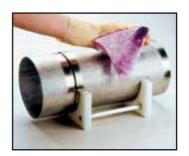
Das WT Zone Tape ist ein Spülgas-Abdeckband mit dem das c-Maß zwischen den Rohren versiegelt und dadurch der Gasverlust während des Spülvorgangs minimiert wird. Durch den kleberfreien Mittelbereich ist ein Schweißen ohne Verunreinigungen möglich.
